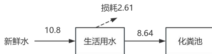
图 2-4 原有项目水平衡图 单位: \text{m}^3/\text{a}
