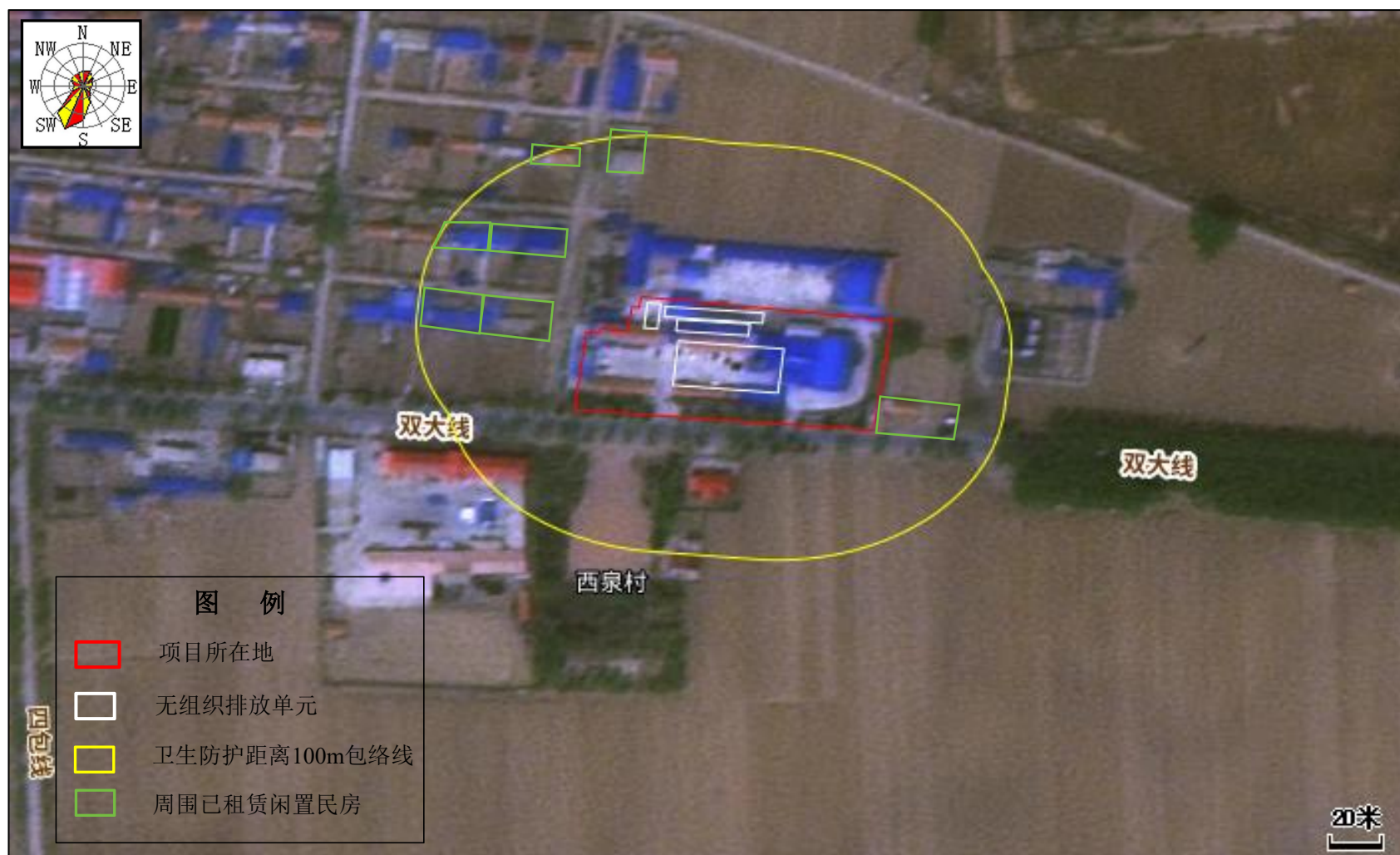
图6.2-1 卫生防护距离包络线图
